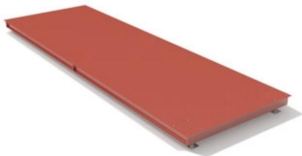
Kit per realizzare una pesa a ponte modulare di nuova generazione, per montaggio a filo piano stradale. Il kit comprende tutti i ponti, la scatola di giunzione, le celle di carico con piastre snodate per autoallineamento e la bulloneria necessaria per realizzare una pesa a ponte.
